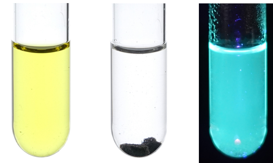
Abb. 5: Von links nach rechts: wässrige Balsalazid-Lösung; dieselbe Lösung nach Umsetzung mit Natriumdithionit; die Produktlösung unter UV-Licht
