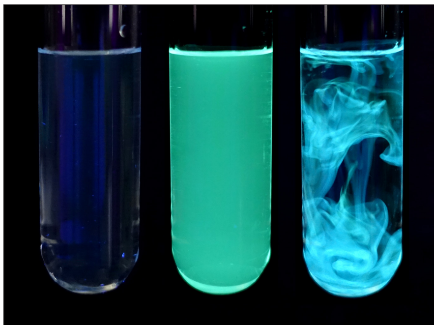
Abb. 3: Das Auftreten und die Farbe der Fluoreszenz einer 5-ASA-Lösung sind pH-abhängig.
