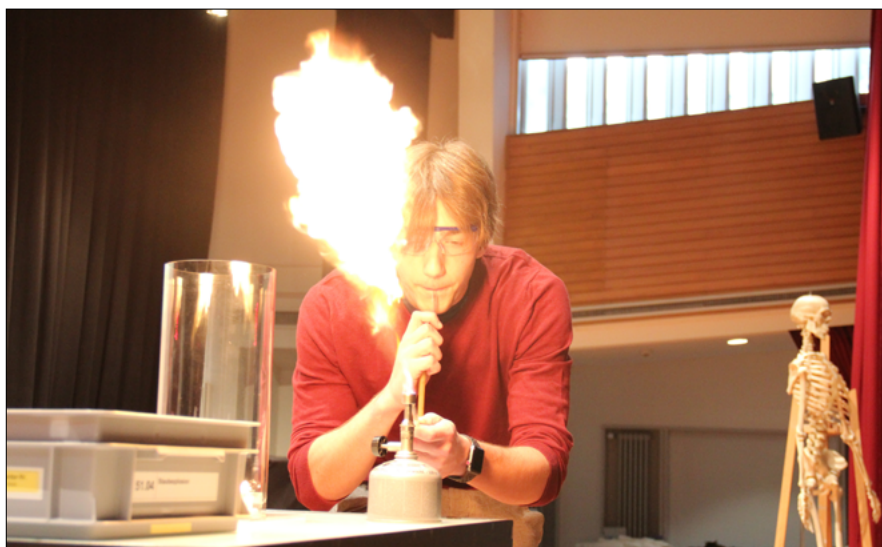
Abb 1: Robin Spichiger illustriert die Gefahr eines hohen Zerteilungsgrads, indem er Staub in eine Flamme bläst.
