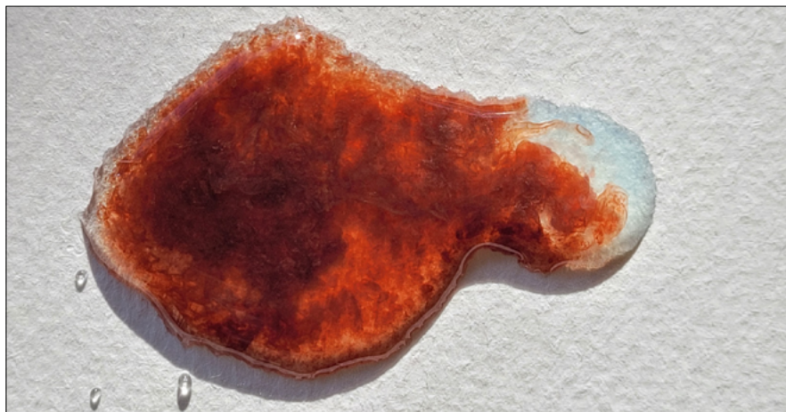
Abb 5: «Amöbe» aus einem Tropfen Kupfersulfat (aq) und einem Tropfen Kaliumhexacyanidoferrat(II) (aq), die durch einen fallenden Wassertropfen verbunden wurden, auf Aquarellpapier
